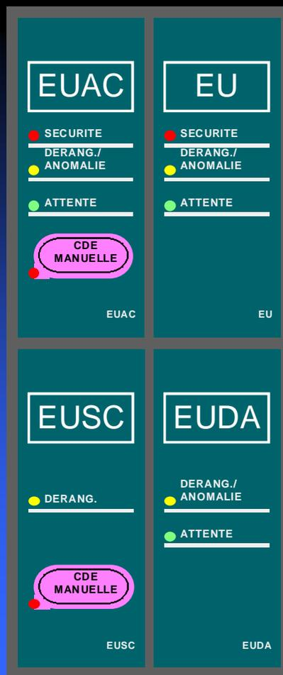
6 types d'étiquette, dont une de masquage « *EIH* », sont disponibles pour équiper les modules D4U ou DE4U qui sont conçus pour matérialiser un maximum de 4 fonctions de mise en sécurité incendie au sens de la signalisation et de la commande (US/UCMC).
